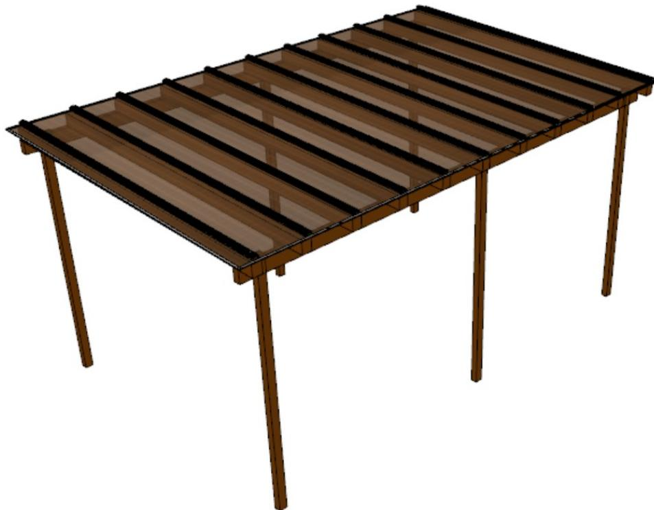
**Figura 1** - Ilustração de uma cobertura de policarbonato alveolar instalado em pergolado.
